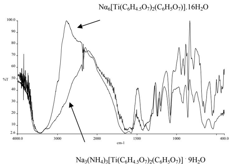
**Fig. 2.** FT-IR spectra of complexes (1)  $\text{Na}_6[\text{Ti}(\text{C}_6\text{H}_4.5\text{O}_7)_2(\text{C}_6\text{H}_5\text{O}_7)] \cdot 16\text{H}_2\text{O}$  and (2)  $\text{Na}_3(\text{NH}_4)_3[\text{Ti}(\text{C}_6\text{H}_4.5\text{O}_7)_2(\text{C}_6\text{H}_5\text{O}_7)] \cdot 9\text{H}_2\text{O}$
